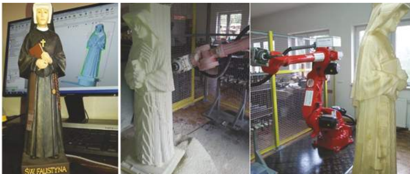
Frezowanie robotem ścieżek zaprojektowanych w ZW3D CAD/CAM
