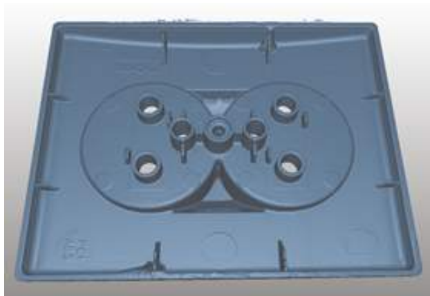
Model MESH uzyskany za pomocą skanera RangeVision Spectrum
