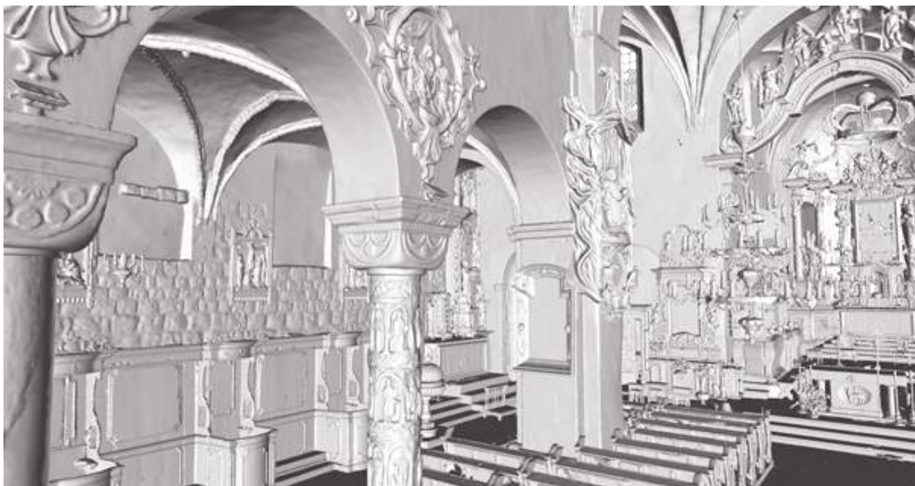
Wyrównane skany wnętrza kościoła wykonane skanerem Ray
