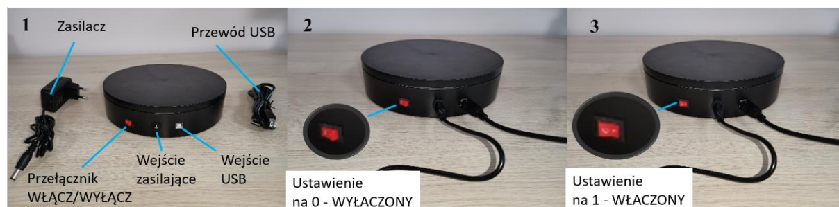
Rysunek 5. Podłączanie stolika obrotowego 1 – Kompletny zestaw stolika, 2 – Podłączony stolik (przewody włączone do stolika i do komputera), 3 – Stolik włączony przełącznikiem.
