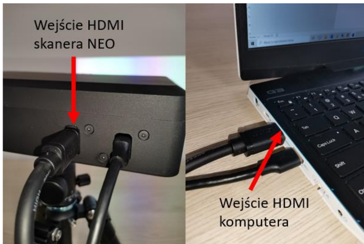
Rysunek 4. Prawidłowe podłączenie kabla HDMI do skanera i komputera.
