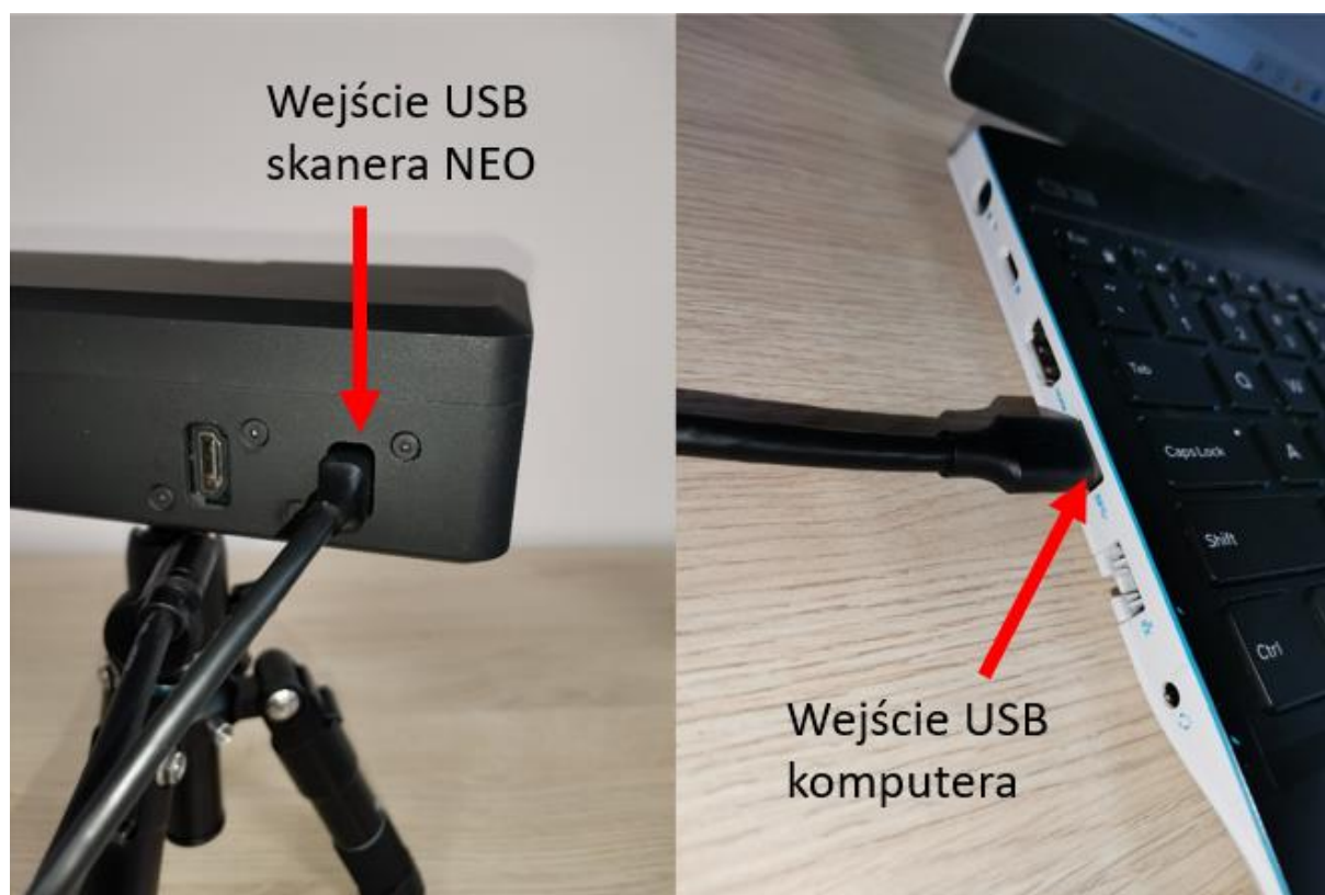
Rysunek 3. Prawidłowe podłączenie kabla USB do skanera i komputera.
